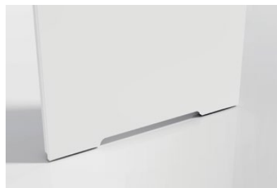
PODCIĘCIE WENTYLACYJNE W DRZWIACH PŁYTOWE 1 podcięcie 15 mm – do pomieszczeń z rekuperacją podcięcie 26 mm – WC dla drzwi 80'-100' podcięcie 38 mm – WC dla drzwi 60'-70'
