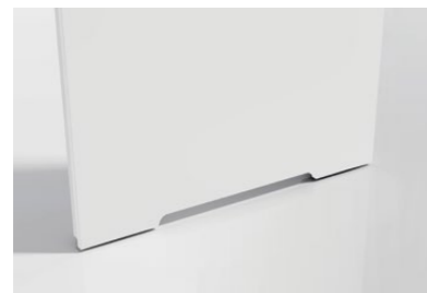
LÜFTUNGSUNTERSCHNITT BEI SPERRTÜREN 1 Unterschnitt 15 mm – für Räume mit Rekuperation Unterschnitt 26 mm – WC für Türen 80'-100' Unterschnitt 38 mm – WC für Türen 60'-70'
